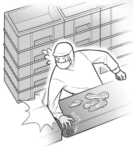
ミキサーなどの食品加工用機械だけでなく、多くの工場で行われているベルトコンベアーにも回転部がある。そこに巻き込まれて大ケガをすることも。
